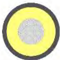
Figur 14: Kabeln igenom skärning, ledare av aluminium med en skärm av koppar.
